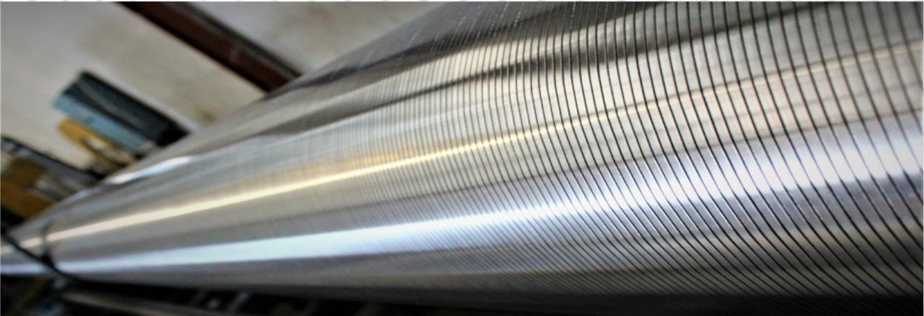
La crépine est fabriquée par un fil en acier inoxydable profilé en V enroulé en spirale et soudé point par point sur un faisceau de génératrice sans aucun métal d'apport. Cette soudure complètement automatique procure un certain nombre d'avantages parmi lesquels :
